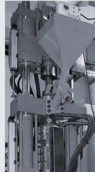
Модульная конструкция позволяет использовать необходимые комбинации шнека и цилиндра для литья различных материалов.
